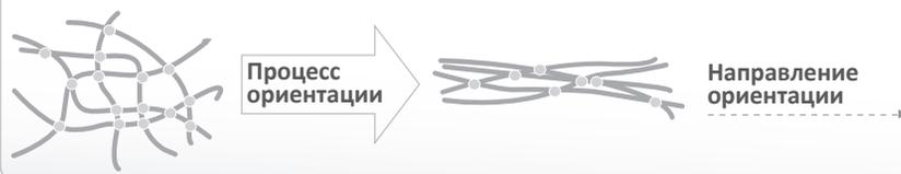
Процесс молекулярной ориентации изменяет структуру ПВХ, придавая молекулам пластика линейную ориентацию.
